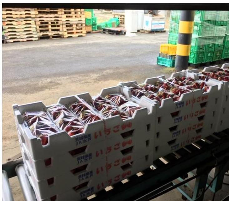
【1】『EPSハーフスペースBOX』の四面にインクジェット印刷を施し、従来の樹脂コンテナに比較すると、商品名がくっきりと目立ちます。【2】出荷検査後、4段づつPPバンドで結束します。【3】パレット積み（4段×4束）して、トラックに積み込みします。
