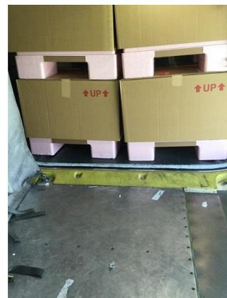
●輸出用のいちごの飛行機輸送テスト。ハブ空港までの輸送をトラックから飛行機への切替を計画。目的は、振動による製品ダメージの軽減。輸送機となる『ボーイング737-800』機の貨物室にピッタリ収まるサイズのパレットを製作し、テストを実施。当社では、お客様と一緒に製品開発を行うことを大切にしています。
